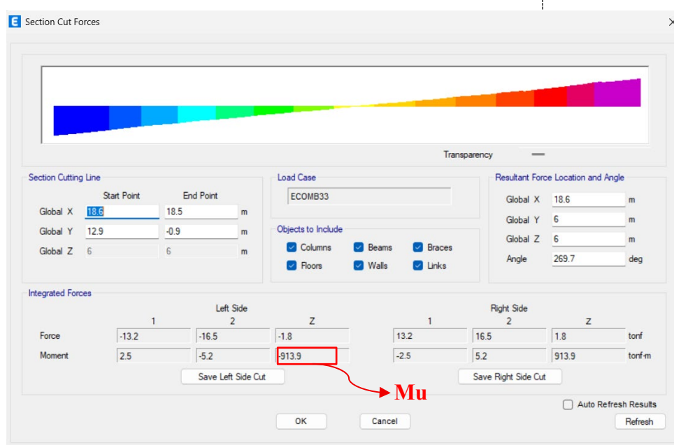
شکل ۶-۱۵- نیروی محوری در واحد طول در دیافراگم
