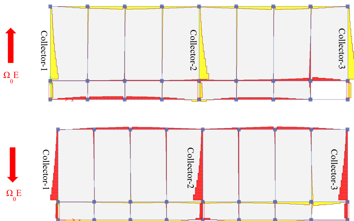
شکل ۶-۲۰- حداکثر نیروی ایجاد شده در جمع‌کننده دیوار برشی
